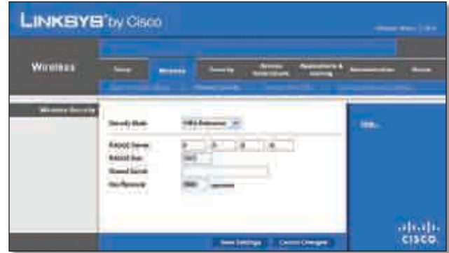
Security Mode > WPA Enterprise (Mode de sécurité > WPA entreprise)
